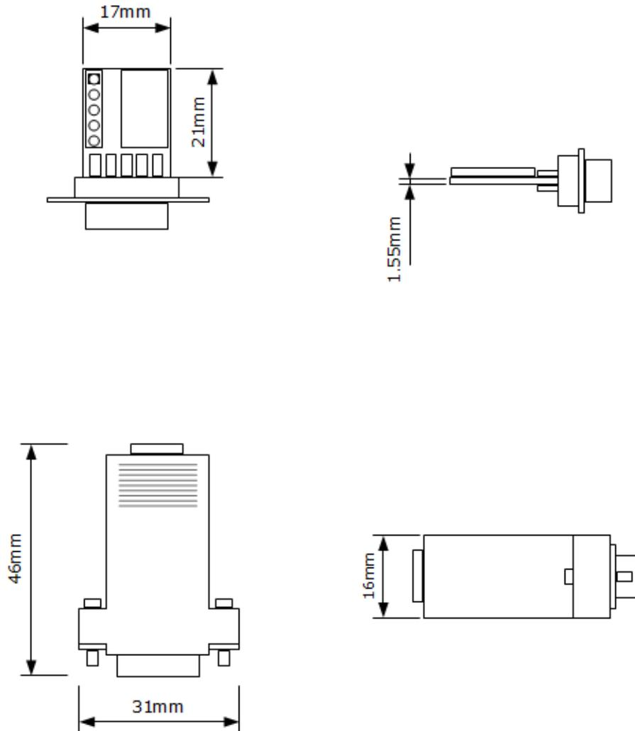
Abbildung 5.1. BLE232 Platinen- und Gehäuseabmessungen
