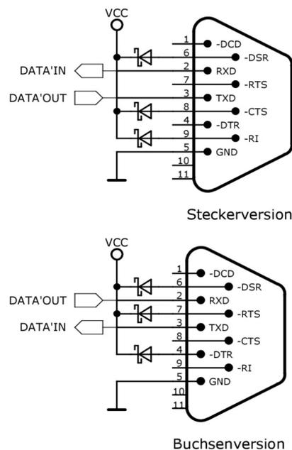
Abbildung 3.1. Anschlusspläne für serielle Schnittstelle und Stromversorgung
